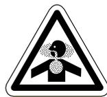
Le mélange d'un produit alcalin et d'un produit acide peut entraîner une réaction chimique. La surchauffe du mélange peut provoquer des projections de composés caustiques ou libérer des fumées, des gaz et des vapeurs dangereux. Toujours rincer abondamment l'appareil à l'eau douce lors du passage d'un produit alcalin à un produit acide ou d'un produit acide à un produit alcalin.
